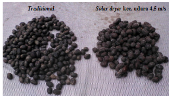
Gambar 13. Perbedaan bentuk fisik biji kopi hasil pengeringan secara tradisional dan solar dryer pada kecepatan udara pengering 4,5 m/s
