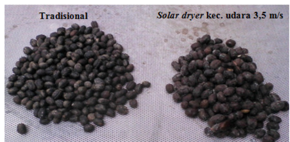
Gambar 9. Perbedaan bentuk fisik biji kopi hasil pengeringan secara tradisional dan solar dryer pada kecepatan udara pengering 3,5 m/s
